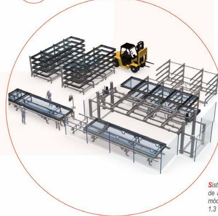
Sistema automático de carga de módulos en rack de almacenamiento, con capacidad de manejo de módulos de máximo 7000 x 2500 mm y un peso de 1.3 TN
