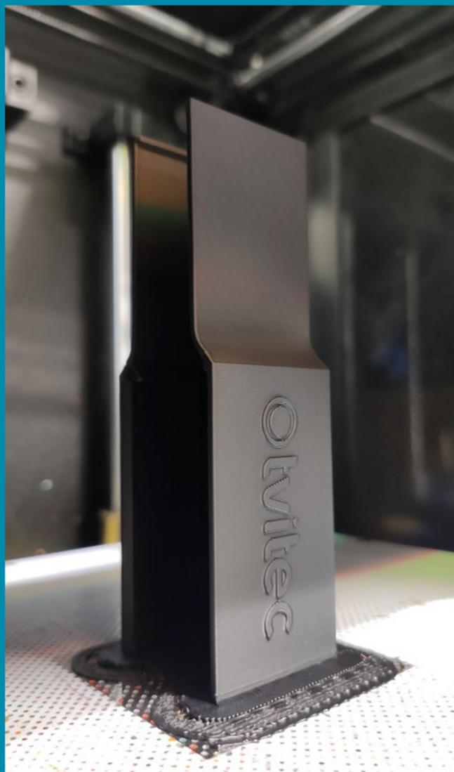
Un primer plano de los protectores en 3D que se han incorporado para la protección de los electrodos.
